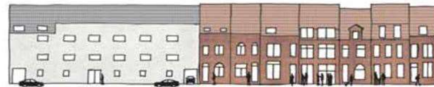
NIET LEVENDE VS LEVENDIGE PLINT DOOR VERTICALE RITMIEK EN GROOT GLASOPPERVLAK OP DE PLINT
